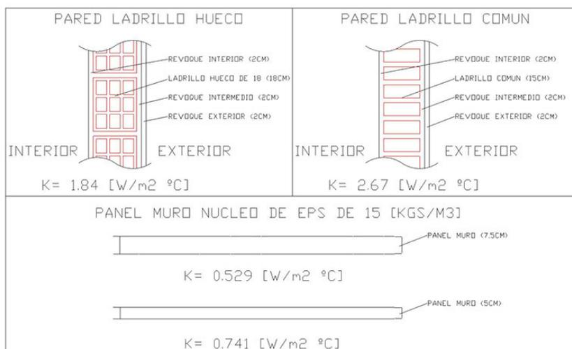
Las paredes de nuestros módulos son confeccionadas con paneles de 75mm con lo que se logra una aislación térmica muy eficiente:
